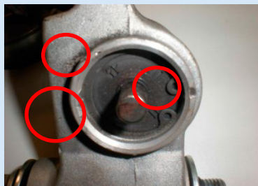
Vtisky a záseky na tele napináku
