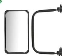
Spätne zrkadlo dĺžka 305.0 mm, šírka 170.0 mm, s držiakom, UNIVERZÁL
