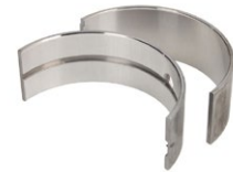
Ložiská kľukového hriadeľa JONH DEERE, +0.25 mm, vnútorný priemer 82 mm, vonkajší priemer 93.5 mm
