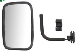
Spätne zrkadlo dĺžka 250.0 mm, šírka 165.0 mm, s držiakom, UNIVERZÁL
